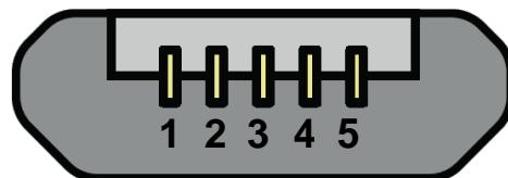
**Рис. 2.5** Разъем micro-USB
