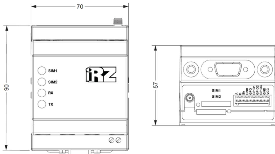
**Рис. 3.2** Габаритные размеры модема ATM – чертёж
